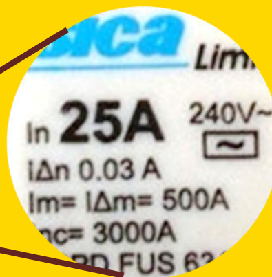
Disyuntor Hogareño Nos salva la vida al detectar fugas de corriente superiores a 0,03 A = 30 mA
